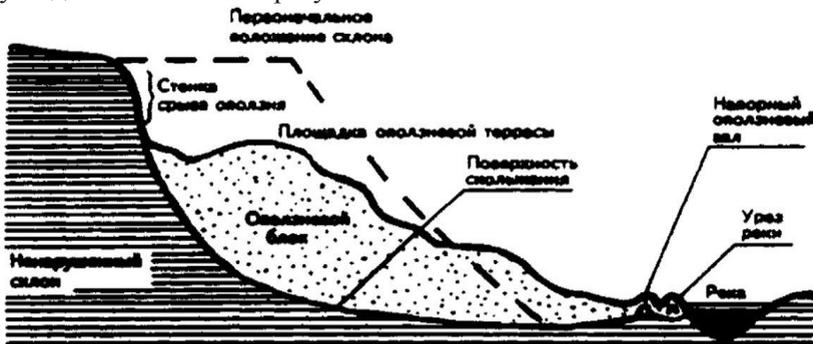
Рис. 4.2. Продольный разрез оползня
