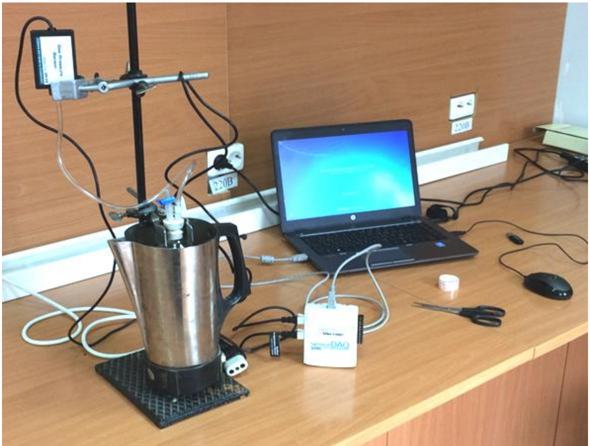
Рис. 7. Установка для проверки закона Шарля.
