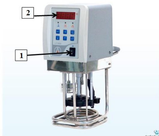
Рисунок 11 - Погружной термостат-циркулятор. Общий вид
