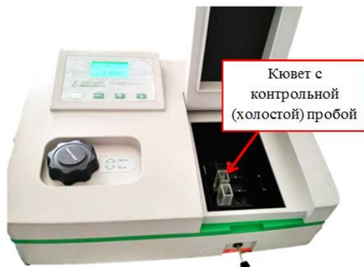
Рисунок 19 - Установка кювета в кюветное отделение
