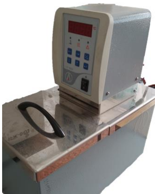
Рисунок 8 - Погружной термостат-циркулятор серии LIOP LT-100 и ванна в кожухе с крышкой
