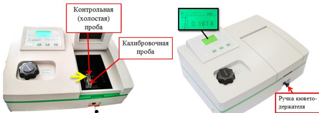
Рисунок 21 - Спектрофотометр с калибровочной пробой: слева – установка кюветов, справа – оценка результата
