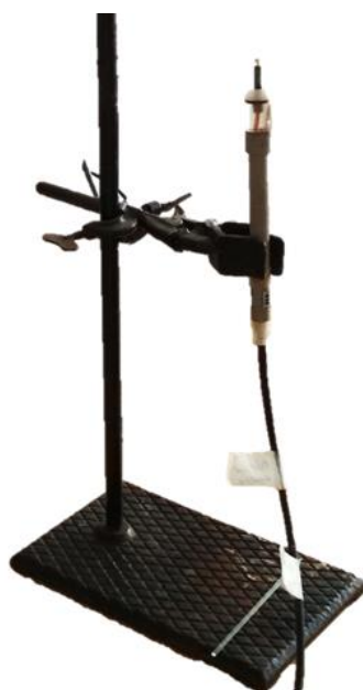
Рисунок 6 - Установка датчика для заполнения его электролитом
