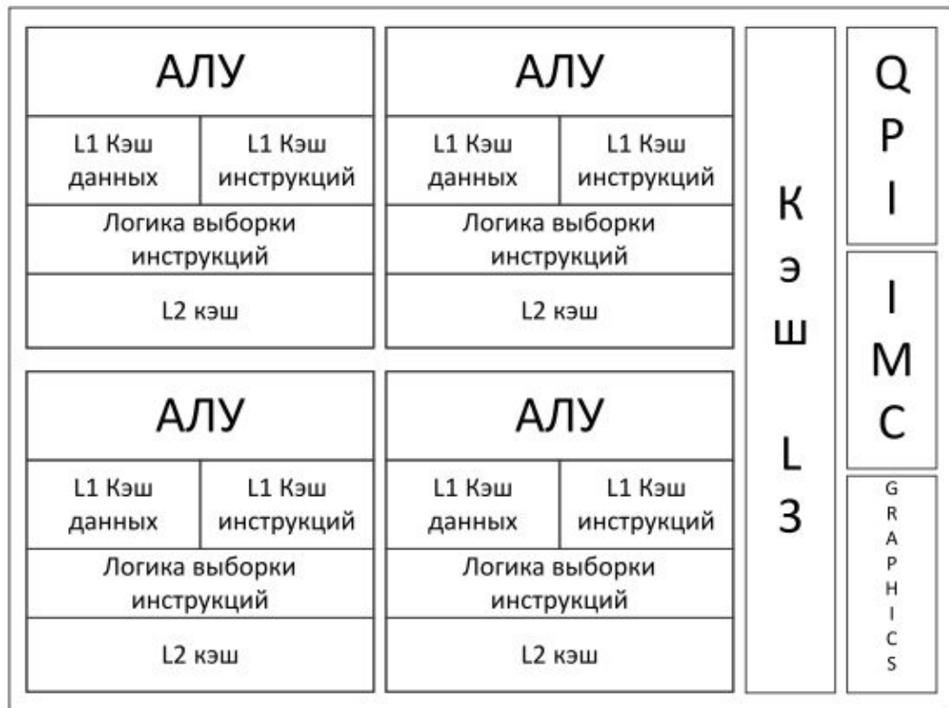
Рис 3. Схематическое устройство процессора Intel.
