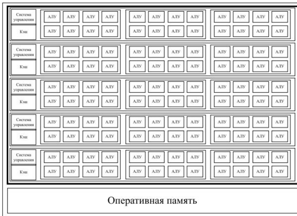
Рис 4. Схематическое устройство графического процессора.
