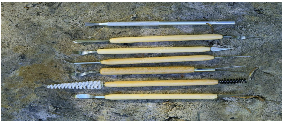
Рисунок 6 – Инструменты для механической расчистки (щадящий способ расчистки) поверхности камня с наскальным изображением [21]
