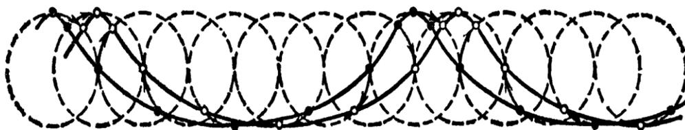
Рис.8 Движение частиц жидкости в волне на ее поверхности
