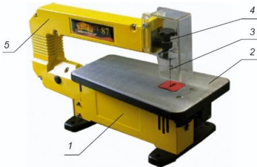
Рис. 65. Электрический лобзик: 1 – электрический двигатель; 2 – распилочный столик; 3 – пилочка; 4 – винты крепления пилочки; 5 – корпус лобзика
