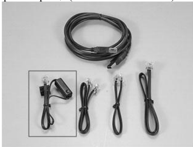
Кабель-переходник для подключения датчиков старого образца (совместимых с RCX) к NXT
