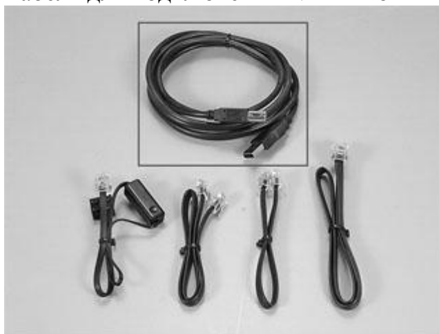
USB кабель для подключения NXT к компьютеру
