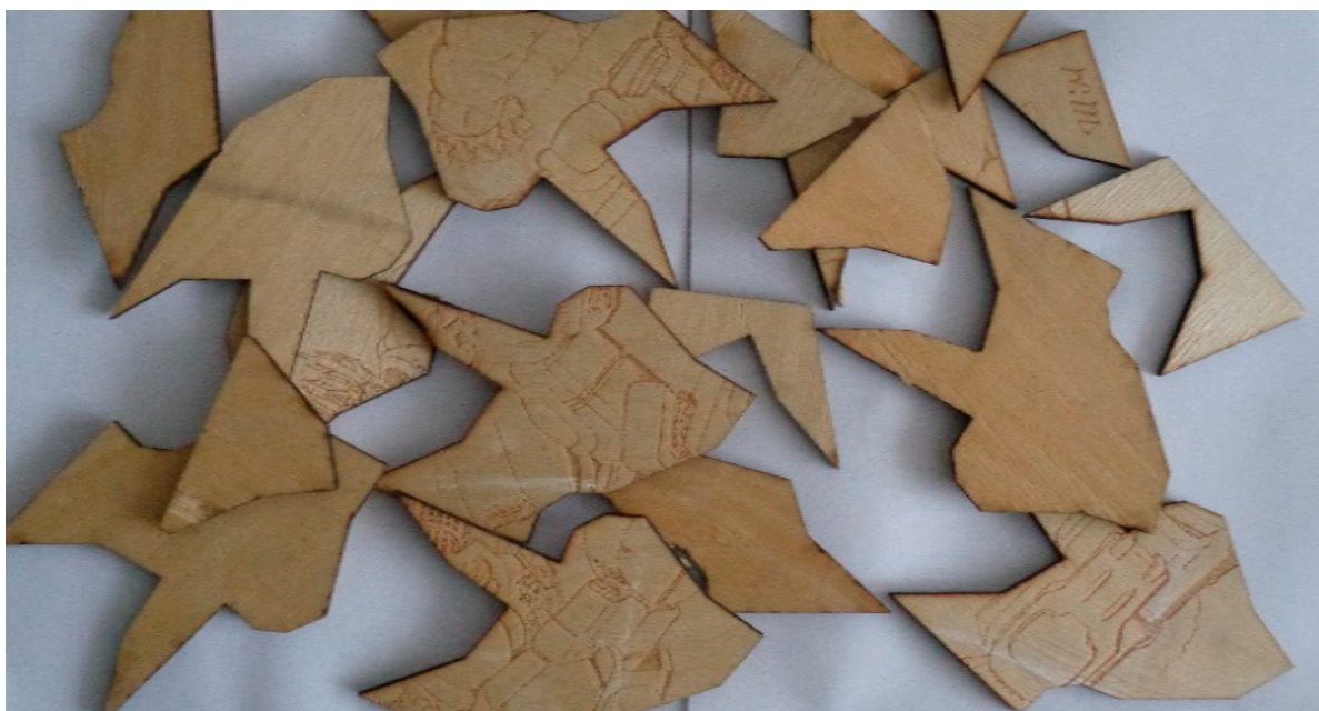
Рис. 3. Пазл – результат лазерной резки
