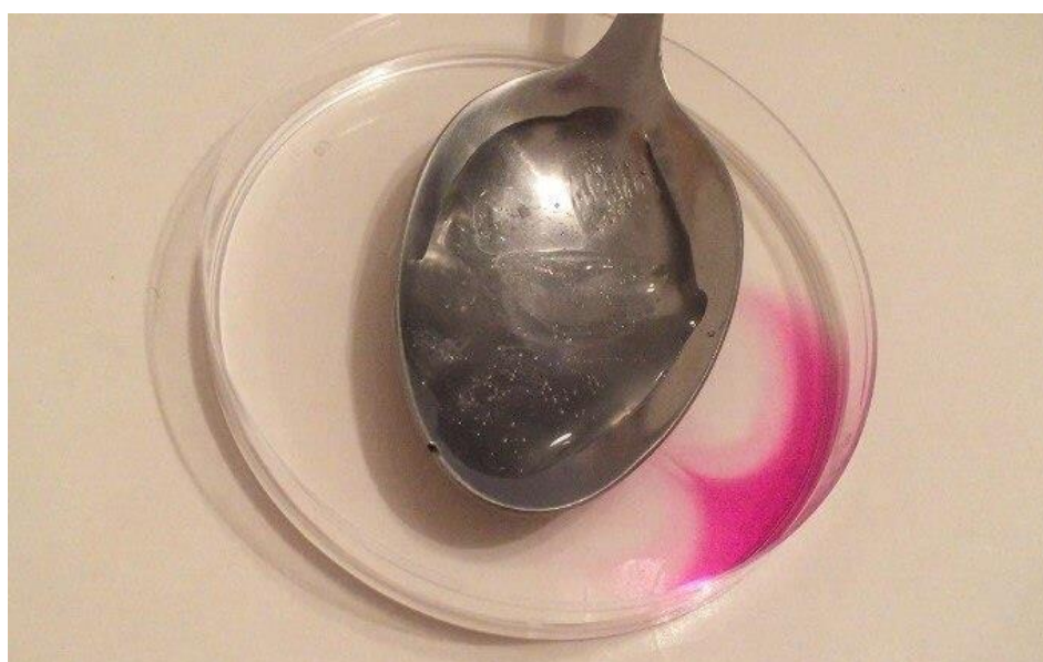
Рис. 6. Динамика развития диффузионного пятна после охлаждения
