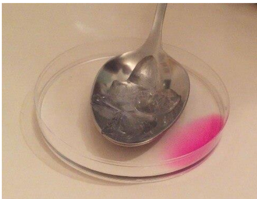
Рис. 3. Динамика развития диффузионного пятна после охлаждения
