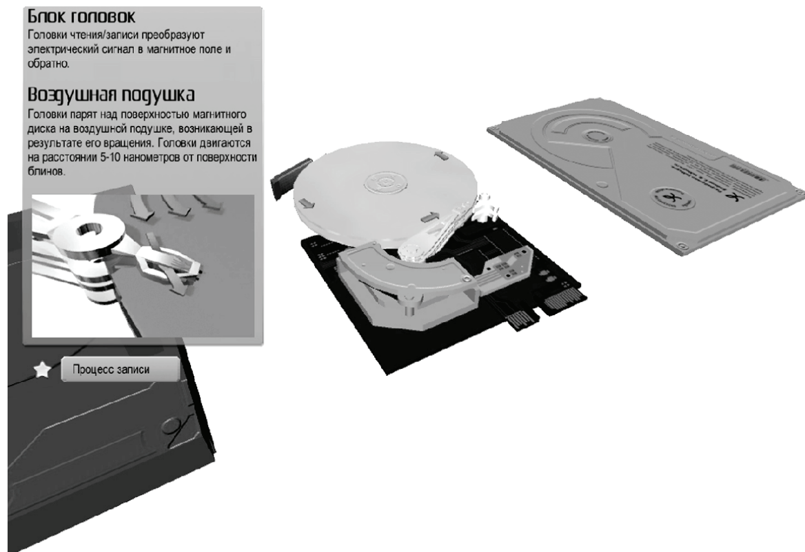
Рис. 6. Воздушная подушка и анимация потоков воздуха
