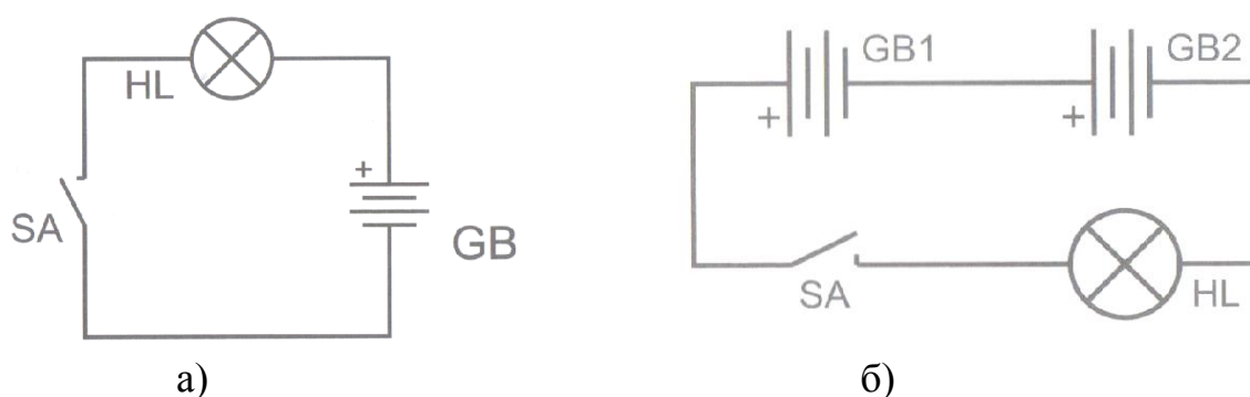
Рис. 1.2. Подключение лампы к двум последовательно соединенным гальваническим элементам, представляющим собой батарею (а) и двумя последовательно соединенным батареям (б).
