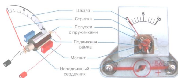
Рис. 4.2. Устройство и принцип действия гальванометра
