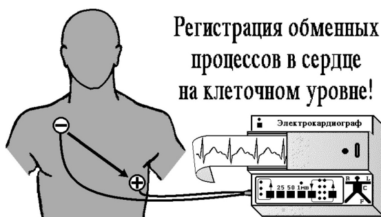
Рис. 13. Регистрация ЭКГ с помощью портативного электрокардиографа с автономным питанием
