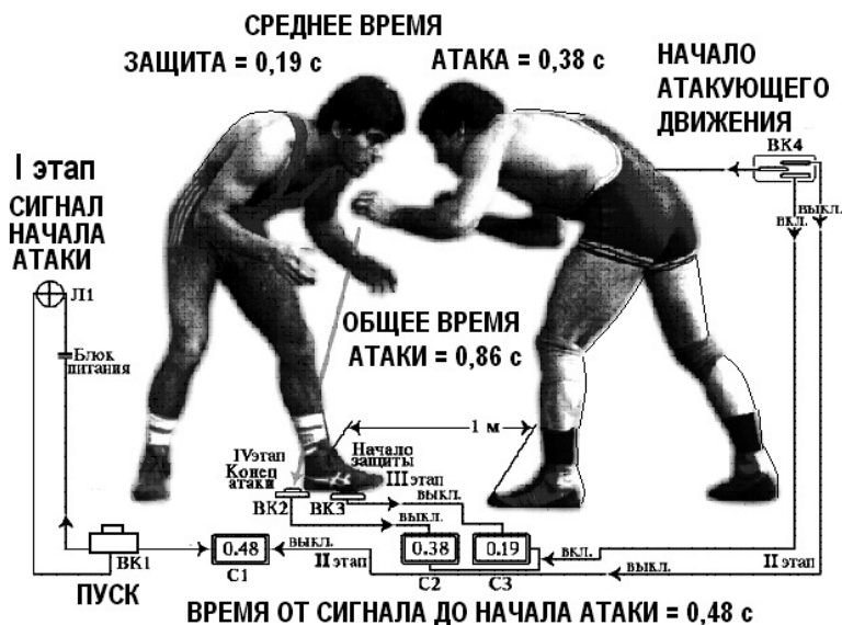
Рис. 48. Стенд для исследования временных параметров атаки в ногу и защиты
