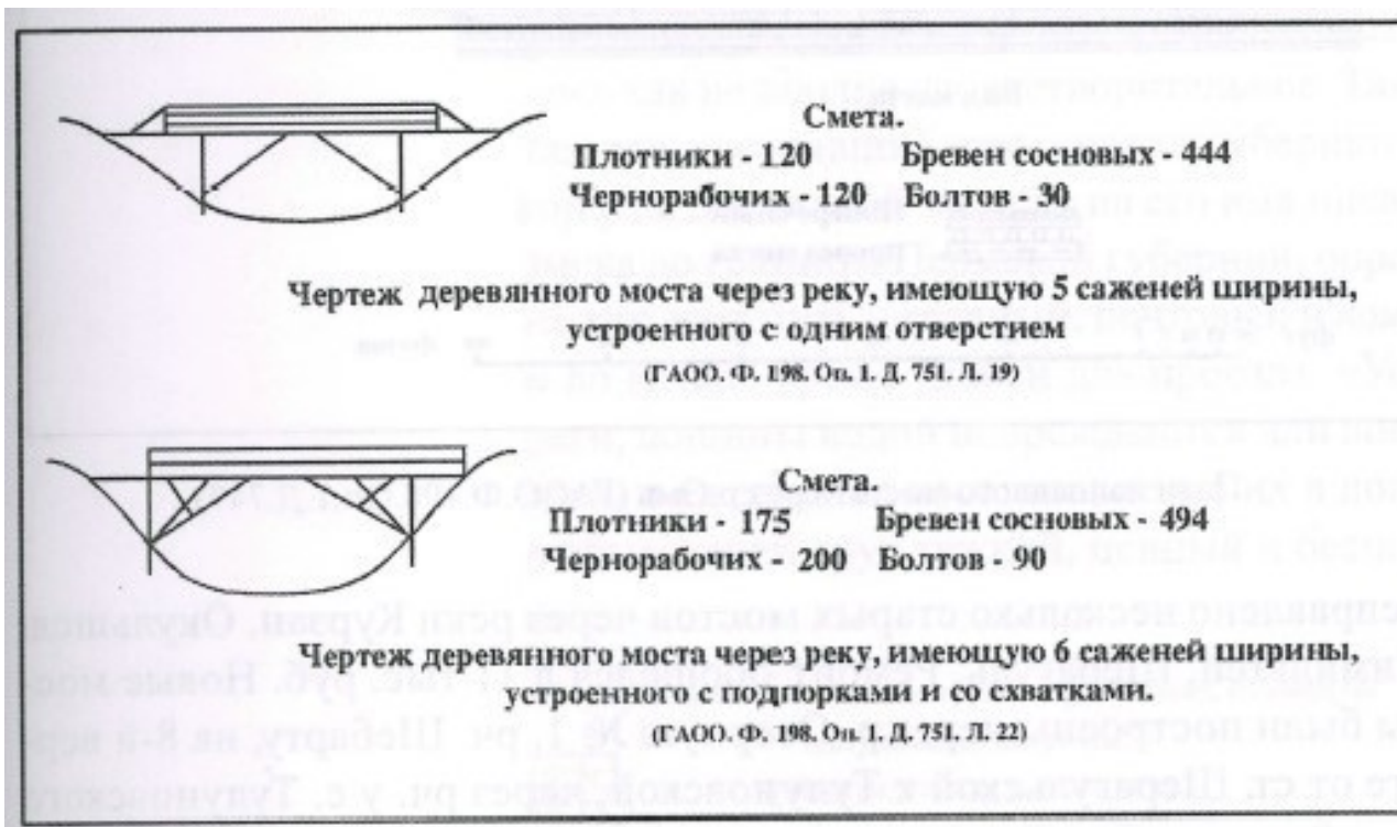
Рис. 6. Чертежи деревянных мостов.
