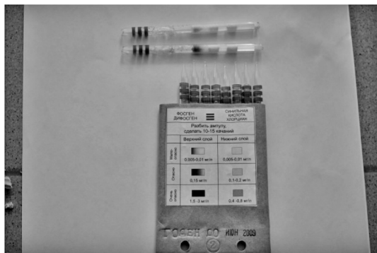
Рис. 7. Индикаторные трубки после отбора газов
