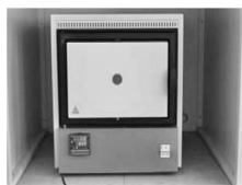
Рис. 1. Муфельная печь LOIP LF-9/11-G1 с модулем управления TS87B
