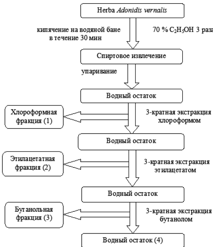
Рис. 1. Схема фракционного разделения фенольных соединений в траве горцивета весеннего
