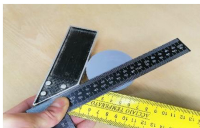
Рис. 6. Нахождение центра с использованием угольника
