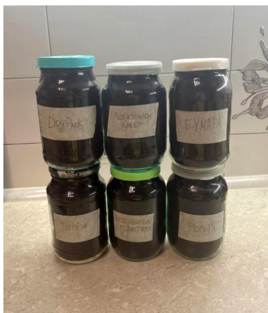
Рис. 3. Образцы упаковочных материалов в почве
