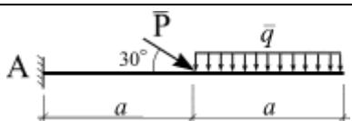
На консоль приложена нагрузка:  $q = 3$  Н/м,  $P = 6$  Н. Определить реакции в жесткой заделке, если  $a = 5$  м. Проверить полученные результаты.
