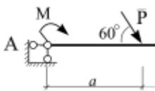
На балку приложена нагрузка:  $M = 2$  Н·м,  $P = 4$  Н. Определить опорные реакции балки, если  $a = 2$  м. Выполнить проверку.
