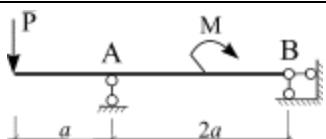
На балку приложена нагрузка:  $M = 4$  Н·м,  $P = 3$  Н. Определить опорные реакции, если  $a = 7$  м. Проверить полученные результаты.
