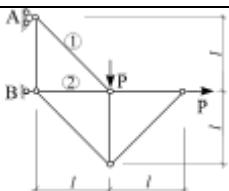
В узлах плоской фермы приложены силы  $P$  величиной по 10 кН. Определить усилия в стержнях 1 и 2 методом моментной точки, если  $l = 5$  м.
