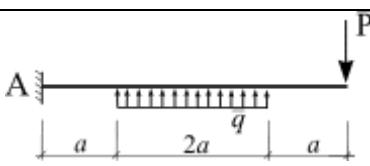
На консоль приложена нагрузка:  $q = 4$  Н/м,  $P = 5$  Н. Определить реакции в жесткой заделке, если  $a = 1$  м. Проверить результаты.
