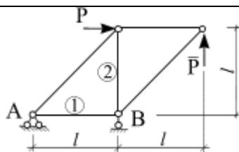
В узлах плоской фермы приложены силы  $P$  величиной по 3 кН. Определить усилия в стержнях 1 и 2 методом вырезания узлов, если  $l = 6$  м.
