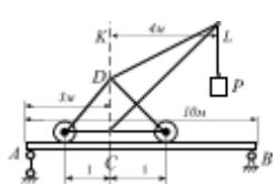
На балке  $AB = 10$  м уложен путь для подъемного крана веса  $Q = 50$  кН, центр тяжести его находится на оси  $CD$ ; вес груза  $P = 10$  кН; вес балки  $AB$  равен 30 кН; вылет крана  $KL = 4$  м; расстояние  $AC = 3$  м. Вычислить опорную реакцию в шарнире  $B$  положения схемы, когда стрела крана  $DL$  находится в одной вертикальной плоскости с балкой  $AB$ .
