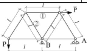
В узлах плоской фермы приложены силы  $P$  величиной по 2 кН. Определить усилия в стержнях 1 и 2 методом Риттера, если  $l = 2$  м.
