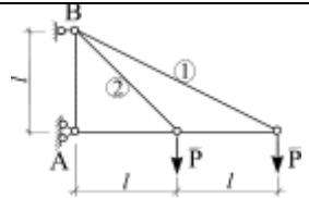
В узлах плоской фермы приложены силы  $P$  величиной по 2 кН. Определить усилия в стержнях 1 и 2 методом Риттера, если  $l = 4$  м.
