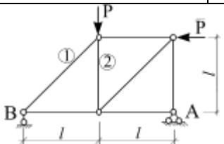
В узлах плоской фермы приложены силы  $P$  величиной по 2 кН. Определить усилия в стержнях 1 и 2 методом вырезания узлов, если  $l = 3$  м.
