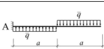
На балку приложена равномерно распределенная нагрузка  $q = 4$  Н/м. Определить реакции в жесткой заделке, если  $a = 3$  м. Проверить результаты.
