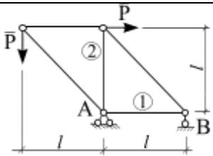
В узлах плоской фермы приложены силы  $P$  величиной по 8 кН. Определить усилия в стержнях 1 и 2 методом вырезания узлов, если  $l = 7$  м.
