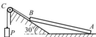
Однородный стержень  $AB$  весом 1000 Н опирается одним концом на гладкий горизонтальный пол, другим – на гладкую поверхность, наклоненную под углом  $30^\circ$  к горизонту. У конца  $B$  стержень поддерживается верёвкой  $BC$ , параллельной наклонной плоскости. Пренебрегая трением на блоке, вычислить давление на наклонную плоскость.
