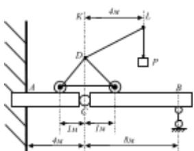
Горизонтальная разрезная балка  $ACB$  концом  $A$  заделана в стену, конец  $B$  опирается на подвижную опору; в точке  $C$  – шарнир. Балка загружена краном веса  $Q = 5$  кН, несущим груз  $P = 1$  кН; вылет  $KL = 4$  м; центр тяжести крана лежит на вертикали  $CD$ . Вычислить, пренебрегая весом балки, опорную реакцию в шарнире  $B$  для положения, если кран находится в одной вертикальной плоскости с балкой  $AB$ .
