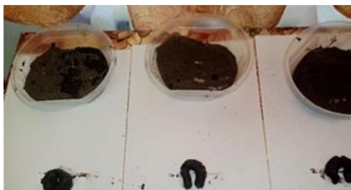
Рис. 32. Определение механического состава почвы с помощью «мокрого» способа.
