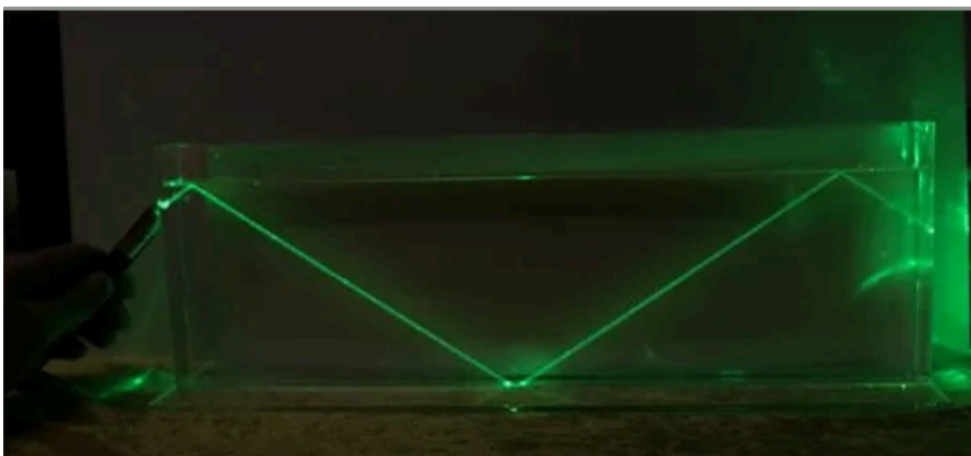
Рис.17 Проверка явления полного внутреннего отражения света
