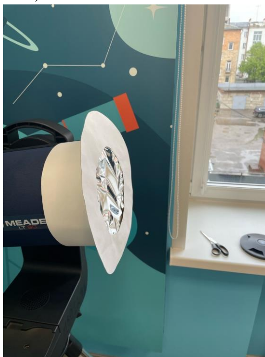
Рис. 23. Солнцезащитный фильтр на телескопе
