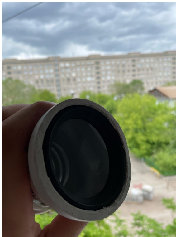
Рис. 8. Отпиленное кольцо со вставленной линзой
