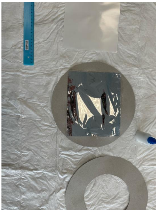
Рис. 20. Защитная пленка закрепленная на кольце
