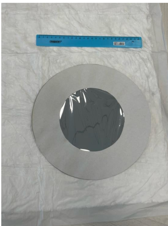
Рис. 21. Защитная пленка закрепленная между двух колец
