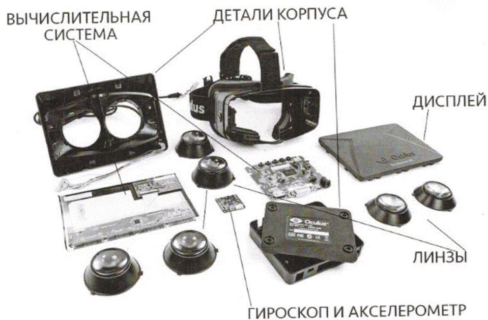
Рисунок 4. Устройство шлема виртуальной реальности
