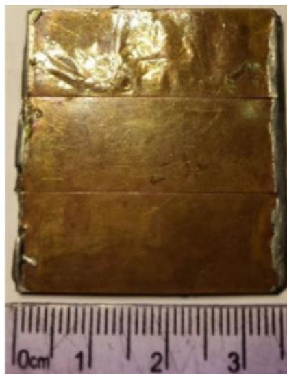
Рис. 6 Платформа из композитных сверхпроводящих лент.
