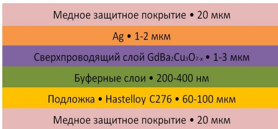
Рис. 8 Схема сверхпроводящей ленты
