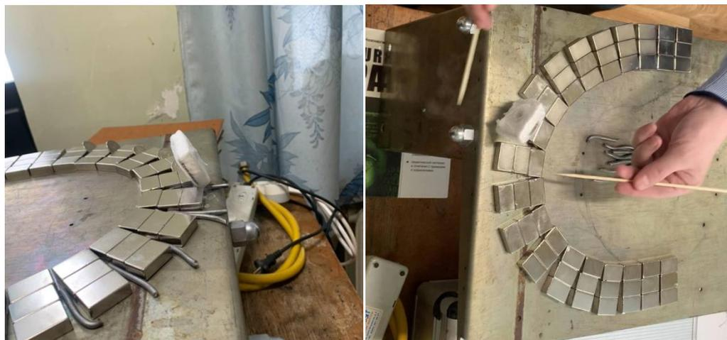
Рис. 8. Левитация магнитоплана над дугообразной дорогой.
