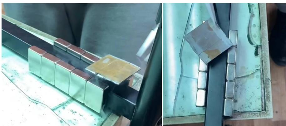
**Рис. 4. Левитация охлажденной ленты над неодимовыми магнитами.**
