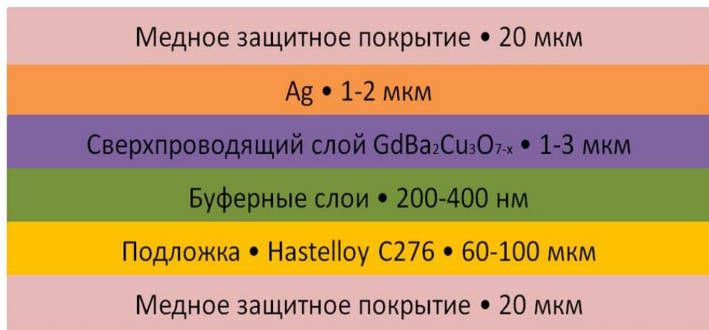
Рис 1. Схема сверхпроводящей ленты.
