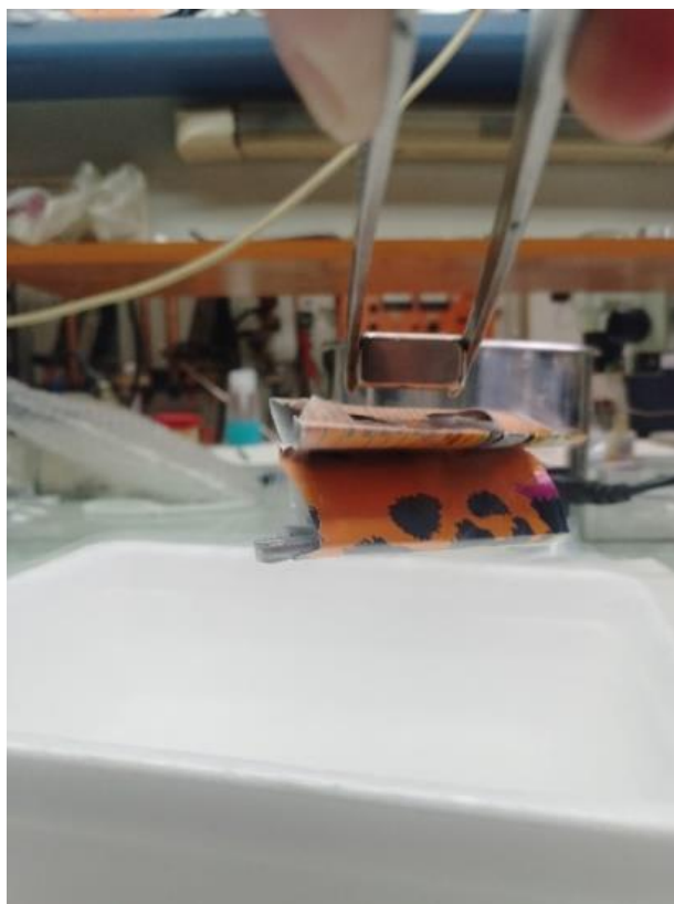
Рис 10. Притяжение сверхпроводящей пластины к неодимовому магниту с подвесом.
