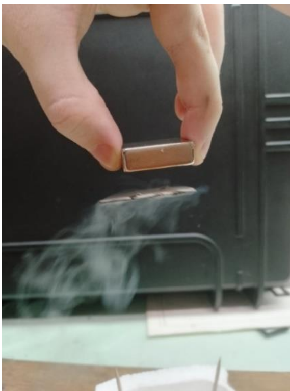
Рис 7. Притяжение сверхпроводящей пластины к неодимовому магниту.
