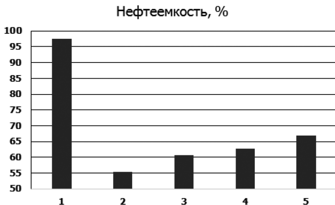
Рис. 2. Результаты определения нефтеемкости образцов (1 – уголь, 2 – цеолит, 3 – прокаленный цеолит, 4 – цеолит с кислотной обработкой, 5 – цеолит с обработкой толуолом)
