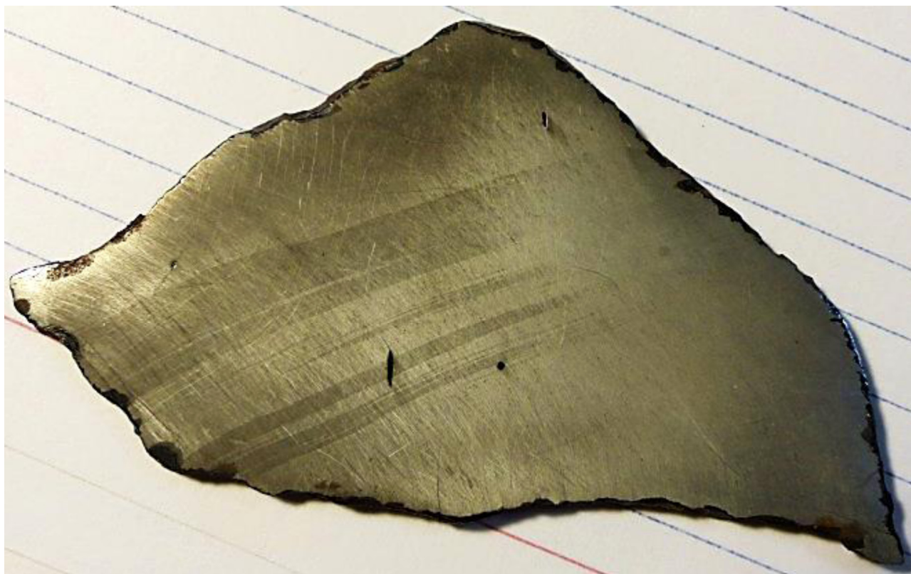
Рис. 2. Протравленный кислотой срез метеорита Чинге (9x5x0,5 см). Фото с сайта [3]
