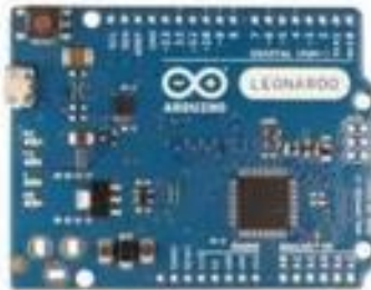
Рис. 2 – Плата Arduino Leonardo
