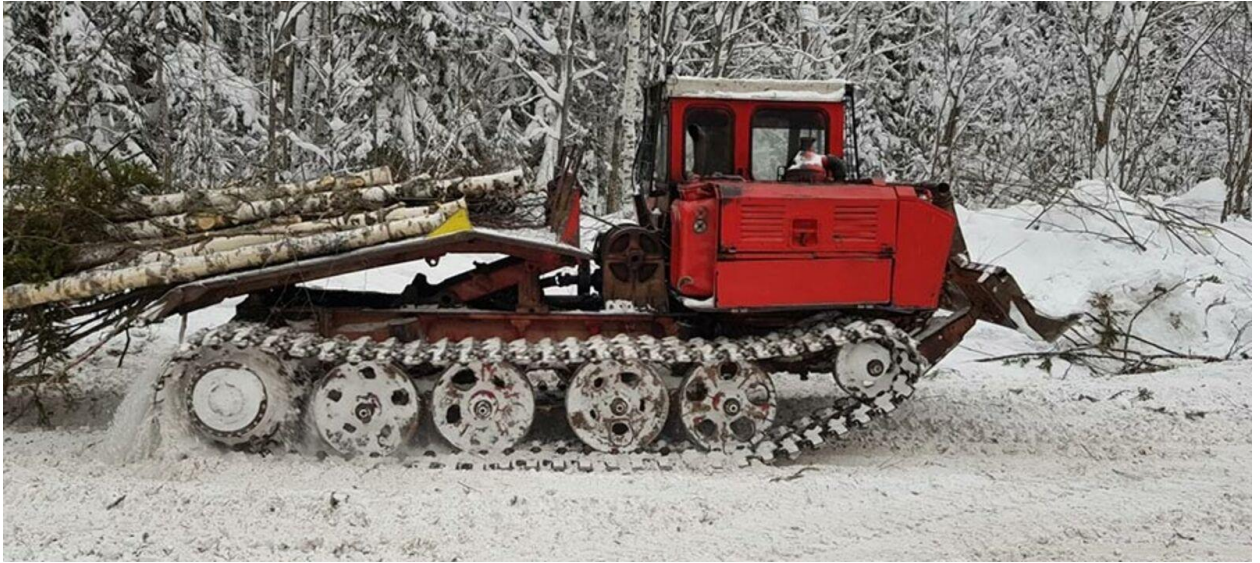
Рисунок 5 – Трелёвочный трактор ТТ-4М, г. Барнаул
