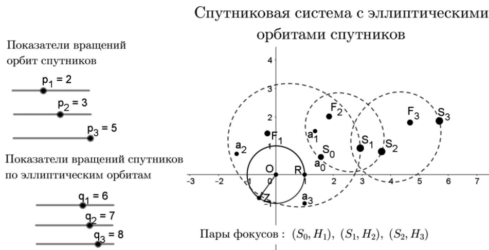
Рис. 4. Каждый спутник вращается по эллиптической орбите, в одном из фокусов которой находится предыдущий спутник
