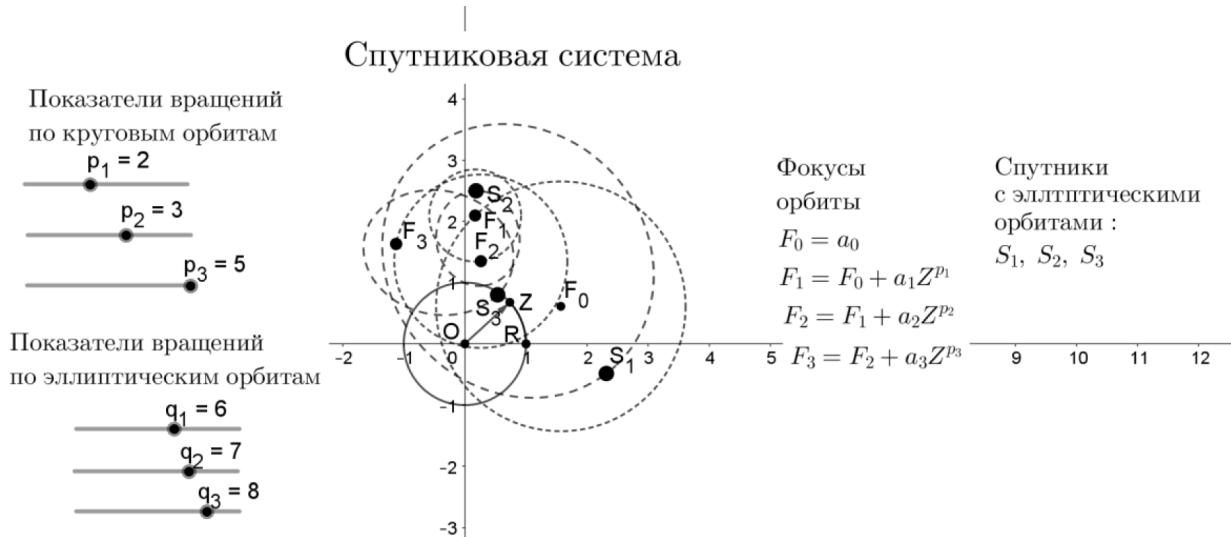
Рис. 3. Спутниковая система с эллиптическими орбитами спутников и круговыми орбитами фокусов
