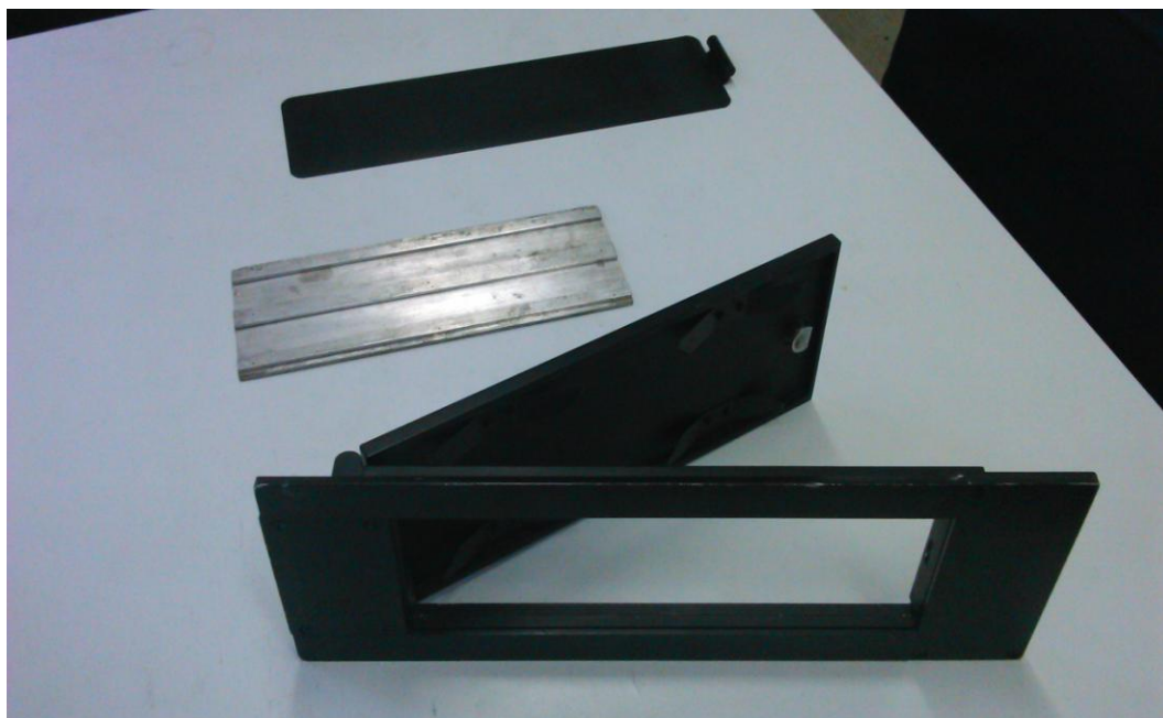
Рис. 4 Фотография крышки крепления пленки к PGS-2 в разборе
