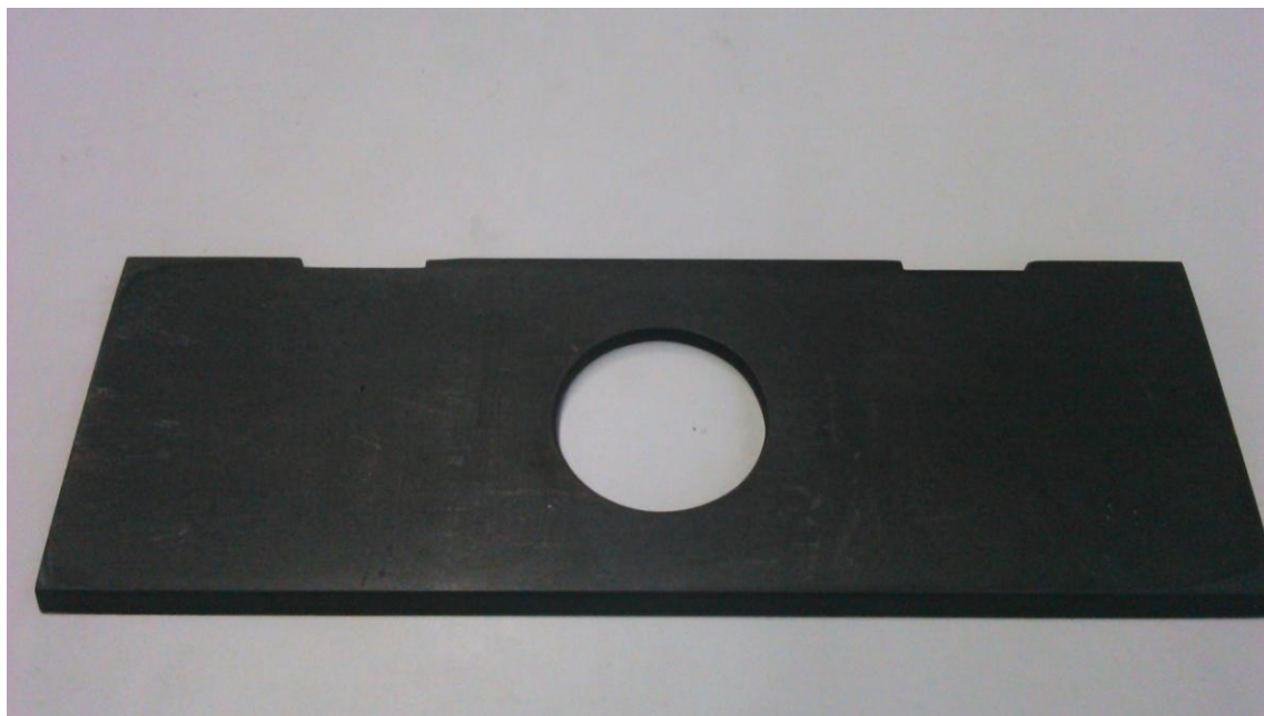
Рис. 9 Крышка для крепления ПЗС матрицы к спектрографу PGS-2
