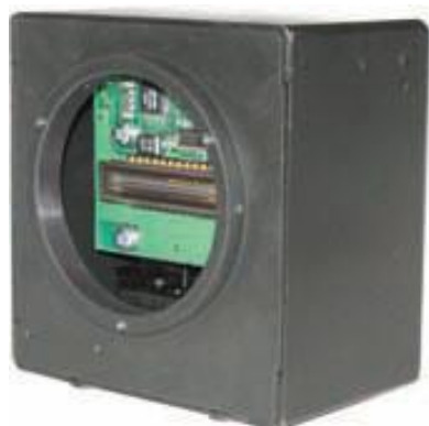
Рис. 8 Внешний вид фотоприемного устройства на основе ПЗС-линейки
