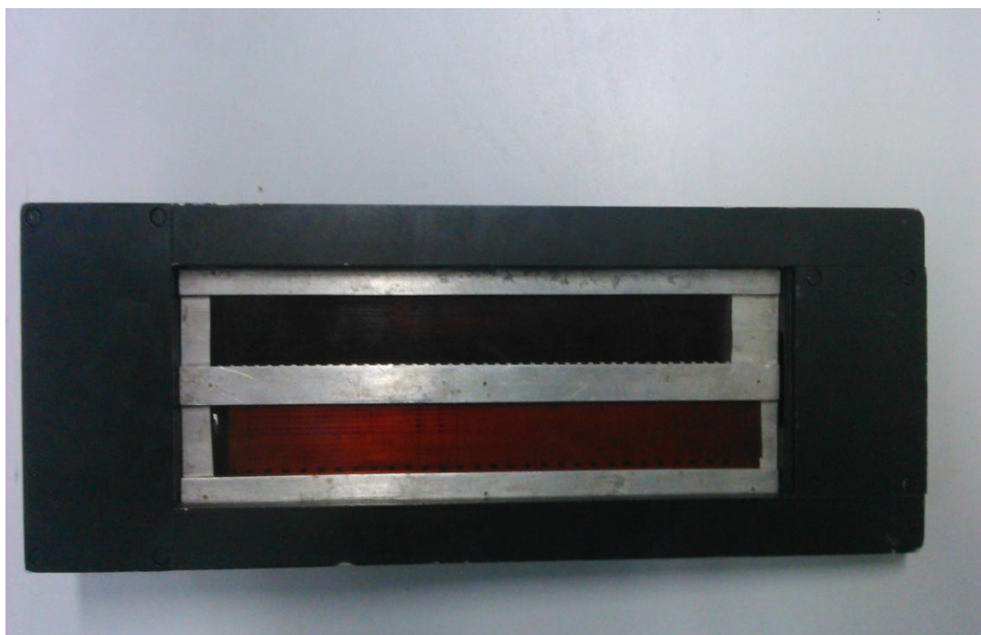
Рис. 5 Фотография крышки крепления пленки к PGS-2 в рабочем состоянии
