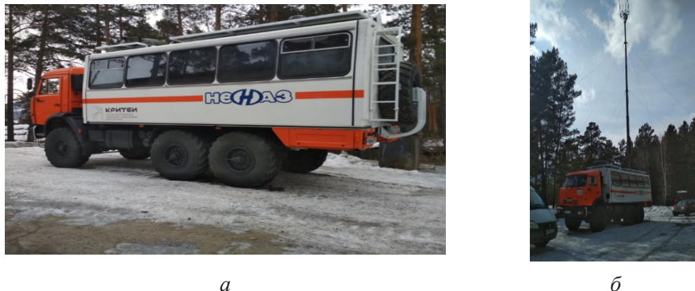
Рис. 2. Разработанный комплекс АПКУ в транспортном положении (а), в развернутом положении с установленными тросовыми растяжками (б)
