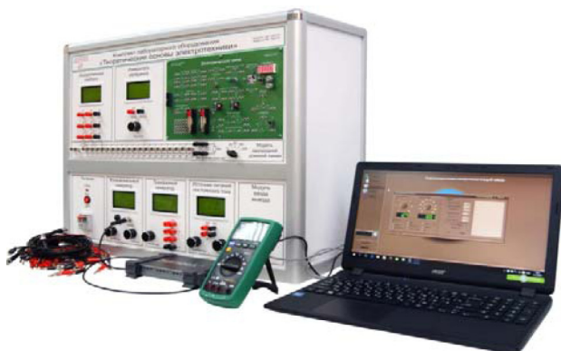
Рис. 1. Макет для практических и лабораторно-практических работ по электротехнике
