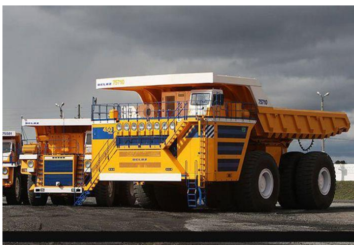
Рисунок 9. Самый большой самосвал в мире – «БелАЗ 75710»
