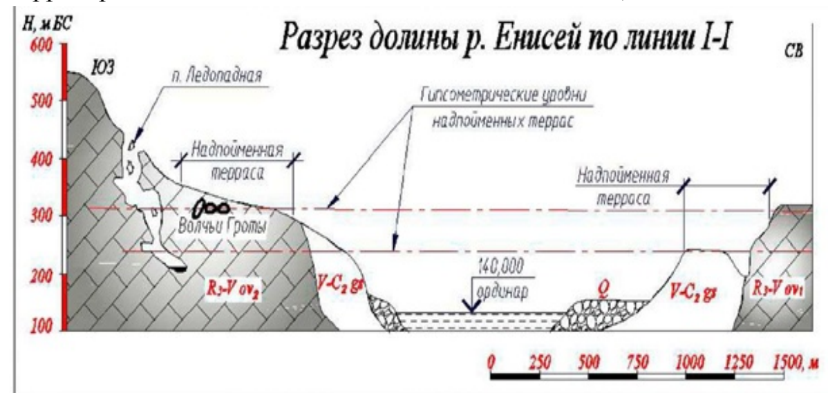
Рис. 2. Геологический разрез долины р. Енисей в створе п. Ледопадная (по В.В. Михееву) [16]
