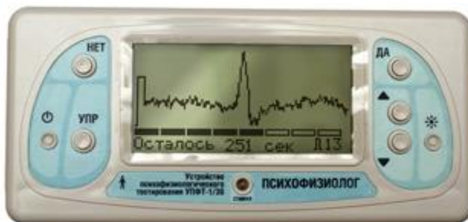
Рис. 2. Устройство психофизиологического тестирования -1/30-«Психофизиолог».
