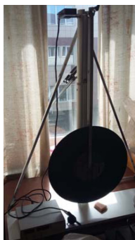
Рис. 5. Установки для измерения момента инерции симметричных тел.
