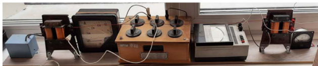
Рис. 1. Модель высоковольтной линии электропередач. Демонстрируется и изучается закон Джоуля–Ленца, производятся измерения КПД ЛЭП с технологией повышения напряжения и без нее
