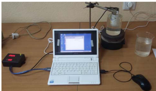
Рис. 4. Установка для изучения фазовых переходов и переохлажденного состояния жидкостей.
