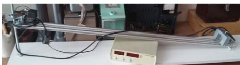
Рис. 5. Установки для измерения момента инерции симметричных тел.
