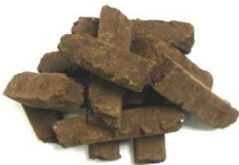
Рисунок 3.7 – Образец брикетов, получаемых из отходов животноводства [41]
