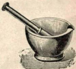
Рис. 168. Фарфоровая ступка для измельченія веществъ.
