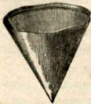
Рис. 14, показывающей, какъ складывается бумажный фильтръ.
