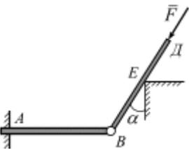
6. Балки  $AB$  и  $BD$  соединены цилиндрическим шарниром  $B$ . Балка  $BD$  опирается на гладкий выступ  $E$ , образуя с вертикалью угол  $\alpha = 30^\circ$ . Вдоль балки  $BD$  действует сила  $F = 10$  кН. Вычислить горизонтальную составляющую реакции в жёстком защемленном сечении  $A$ , пренебрегая массой балок.
