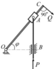
4. В кулисном механизме при качении рычага  $OC$  вокруг горизонтальной оси  $O$  ползун  $A$ , перемещаясь вдоль рычага  $OC$ , приводит в движение стержень  $AB$ , движущийся в вертикальных направляющих  $K$ . Даны размеры:  $OC = R$ ,  $OB = \ell$ . Какую силу  $Q$  надо приложить перпендикулярно кривошпицу  $OC$  в точке  $C$  для того, чтобы уравновесить силу  $P$ , направленную вдоль стержня  $AB$  вверх.
