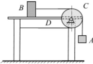
1. Груз  $A$  массой  $M_1$ , опускаясь вниз, приводит в движение посредством нерастяжимой нити, переброшенной через неподвижный блок  $C$ , груз  $B$  массой  $M_2$ . Вычислить силу давления стола  $D$  на пол, если масса стола равна  $M_3$ . Массой нити пренебречь.
