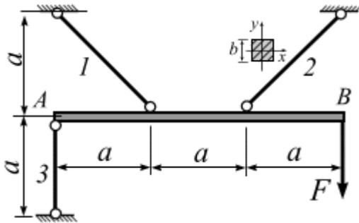
Жёсткая балка  $AB$  удерживается в равновесии стержнями и нагружена, как показано на рисунке. Подобрать необходимое поперечное сечение тяги 2, если  $a = 1,5 \text{ м}$ ;  $F = 140 \text{ кН}$ ;  $R = 240 \text{ МПа}$ . Вычислить перемещение стержня 2, принять модуль упругости материала  $E = 2 \cdot 10^5 \text{ МПа}$ .
