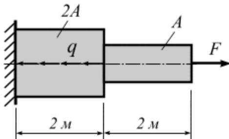
При каком значении « $F$ » полное перемещение стержня станет равным нулю?
