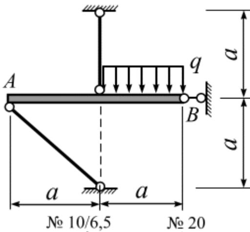
Жёсткий брус  $AB$  закреплён и нагружен, как показано на рисунке. Проверить прочность конструкции, если  $a = 1,5$  м;  $q_n = 30$  кН/м ( $\gamma_f = 1,4$ );  $R = 240$  МПа;  $\gamma_c = 0,9$ ; площади поперечных сечений тяг одинаковы – равнополочные уголки № 6 ( $60 \times 60 \times 5$  мм).
