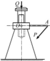
5. Груз  $Q$  поднимается с помощью домкрата, который приводится в движение рукояткой  $OA = 0,6$  м. К концу рукоятки перпендикулярно ей, приложена сила  $P = 160$  Н. Определить величину силы тяжести  $Q$ , если шаг винта домкрата  $h = 12$  мм.
