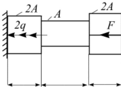
Для ступенчатого бруса требуется подобрать площади поперечных сечений для каждой ступени. Дано нагрузки  $F = 110$  (кН),  $q = 168$  (кН/м), расчетное сопротивление материала растяжению и сжатию
