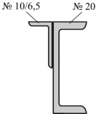
Для заданного несимметричного поперечного сечения, состоящего из двух профилей, требуется найти положение центральных осей и вычислить значения центрального момента инерции  $J_x$ .
