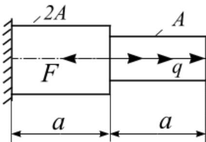
Для ступенчатого бруса требуется подобрать площади поперечных сечений для каждой ступени. Дано нагрузки  $F = 110 \text{ (кН)}$ ,  $q = 168 \text{ (кН/м)}$ , расчётное сопротивление материала растяжению и сжатию
