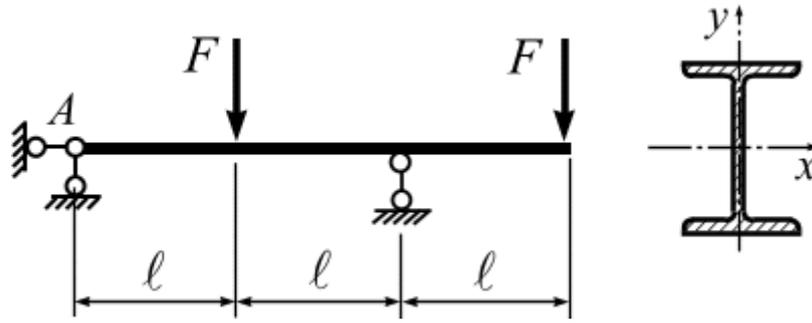
Подобрать двутавровое поперечное сечение балки.
