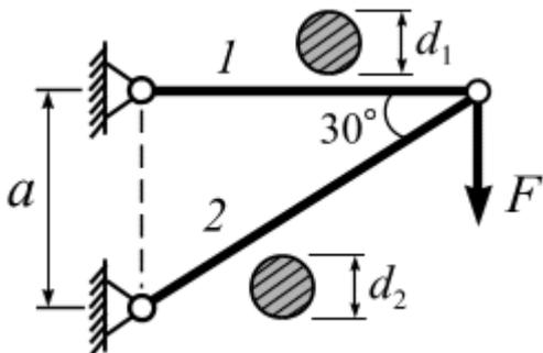
Подвеска из двух стержней 1 и 2 круглого поперечного сечения нагружена силой  $F$ . Требуется подобрать поперечные сечения стержней из условия их прочности.
