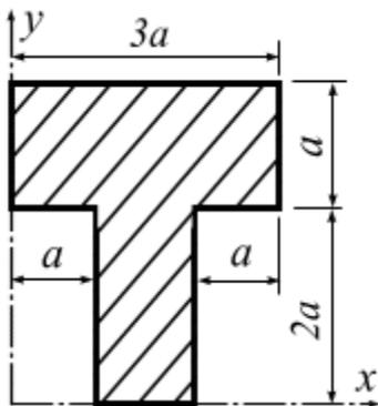
Определить положение центра тяжести Т-образного сечения. Вычислить значение центрального момента инерции  $J_x$ .
