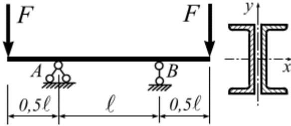
Для двухопорной балки, составленной из двух швеллеров, требуется:
