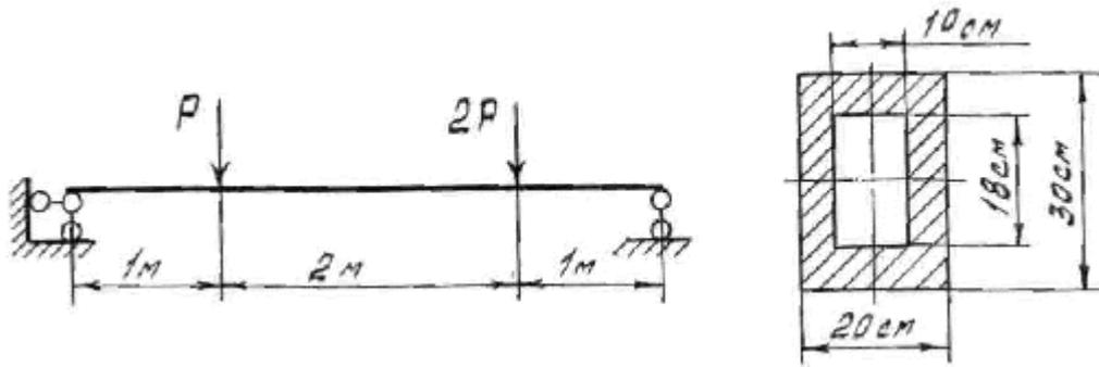
Определить несущую способность балки, если расчётное сопротивление материала  $R = 200 \text{ МПа}$ .
