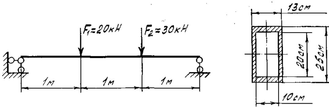
Определить максимальные нормальные напряжения в опасном сечении балки.
