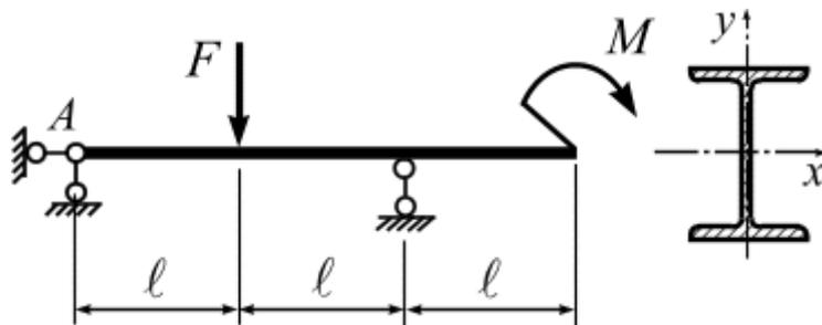
Подобрать двутавровое поперечное сечение балки.
