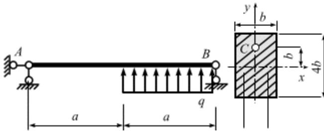
Подобрать размеры поперечного сечения балки, если  $a = 2$  м;  $F_n = 30$  кН,  $q_n = 40$  кН/м,  $R = 240$  МПа. Вычислить напряжение в точке C опасного сечения.
