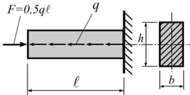
Для бруса прямоугольного сечения требуется определить несущую способность ( $q = ?$ ). Дано: длина бруса  $l = 0,5 \text{ м}$ ; размеры сечения  $b = 3 \text{ см}$ ,  $h = 6 \text{ см}$ ; расчётное сопротивление материала  $R = 200 \text{ МПа}$ .
