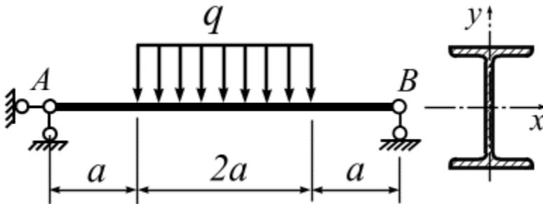
Для двухпорной стальной балки требуется:  $Q_y$  и  $M_x$ .
