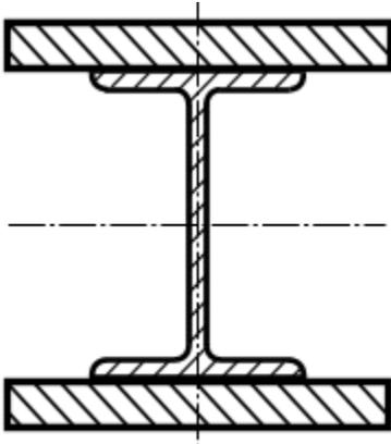
Вычислить величину центрального момента инерции  $J_x$  симметричного сварного сечения, составленного из двух листов прямоугольного сечения ( $5 \times 15 \text{ см}$ ) и двутавра №30.
