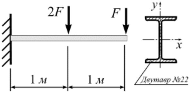
Проверить прочность сечение балки из условия прочности, если  $F = 5 \text{ кН}$ , расчётное сопротивление материала  $R = 210 \text{ Мпа}$ .
