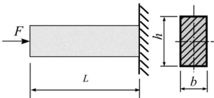
Деревянная консольная балка длиной  $L$  и прямоугольного сечения нагружена на конце силой  $F = 1800 \text{ Н}$ . Подобрать размеры  $b$  и  $h$  сечения балки из условия прочности, если отношение сторон сечения  $h/b = 2$ , расчётное сопротивление материала  $R = 200 \text{ МПа}$ .
