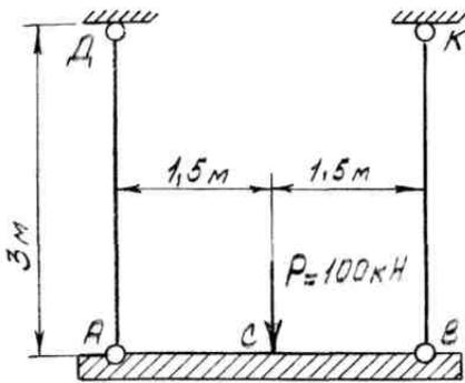
Поперечина  $AB$  подвешена на стальных тросах. Диаметр троса  $AD$  – 20 мм, троса  $BK$  – 25 мм;  $E = 2 \cdot 10^5$  МПа.
