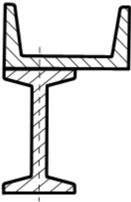
Определить величину центрального момента инерции  $J_x$  сварного сечения, составленного из прокатных профилей: два швеллера № 36; двутавр № 14.
