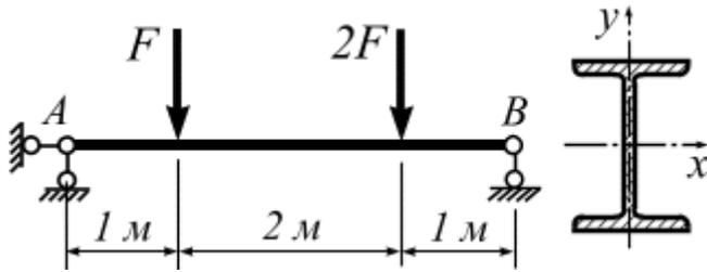
Определить несущую способность двуглавой балки из условия прочности.
