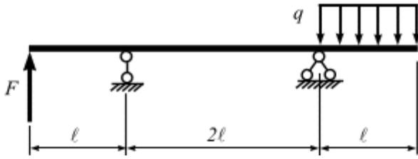
Построить эпюры внутренних силовых факторов  $Q$  и  $M$ . Подобрать сечение балки из условия прочности, если  $q = 5 \text{ кН/м}$ ,  $\ell = 1 \text{ м}$ ,  $F = 20 \text{ кН}$ , расчётное сопротивление материала  $R = 210 \text{ Мпа}$ .
