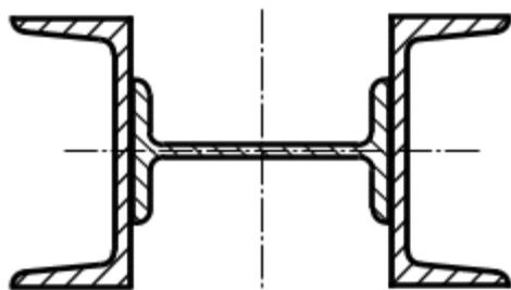
Определить величину центрального момента инерции  $J_x$  симметричного сварного сечения, составленного из прокатных профилей: два швеллера № 36;
