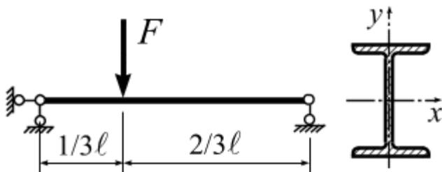
Задача. Для двухпорной балки требуется подобрать двуглавое сечение из условия прочности.
