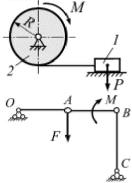
9. Вычислить момент пары сил  $M$  при равномерном перемещении груза весом  $P = 4$  кН, если коэффициент трения скольжения  $f = 0,2$ . Радиус барабана 2 равен  $R = 10$  см.
