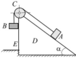
2. Груз  $A$  массой  $M_1$ , опускаясь вниз по наклонной плоскости  $D$ , образующей угол  $\alpha$  с горизонтом, приводит в движение посредством нерастяжимой нити, переброшенной через неподвижный блок  $C$ , груз  $B$  массой  $M_2$ . Вычислить горизонтальную составляющую давления наклонной плоскости  $D$  на выступ пола  $E$ . Массой нити пренебречь.
