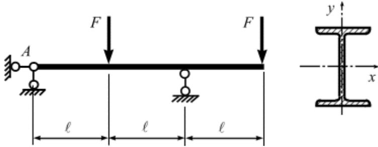
Подобрать двутавровое поперечное сечение балки.
