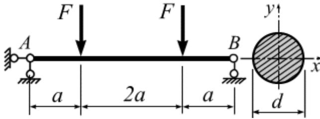
Для двухопорной стальной балки круглого поперечного сечения требуется:
