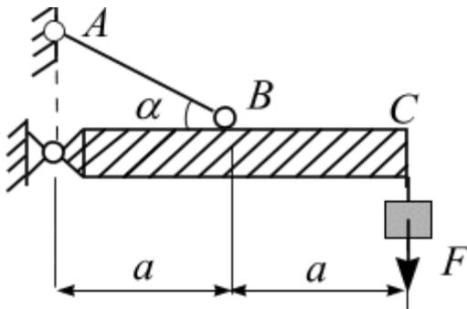
К жесткой балке  $OC$  подвешен груз  $F$ . Балка удерживается тягой  $AB$  круглого поперечного сечения диаметром  $d$ . Расчетное сопротивление материала тяги  $R$ . Какой наибольший груз  $F$  может выдержать данная конструкция из условия прочности тяги  $AB$ ?
