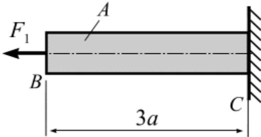
Для стального ступенчатого бруса определить перемещение свободного конца B.
