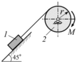
8. Барабан  $r = 30$  см под действием пары сил с моментом  $M = 20$  Н·м приводит в движение груз 1. Вычислить вес груза  $G_1$ , необходимый для его равномерного подъема по наклонной плоскости.
