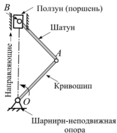
Рис. 2.7. Схема кривошипно-шатунного механизма
