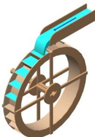
Рис. 8. Устройство наливного водяного колеса
