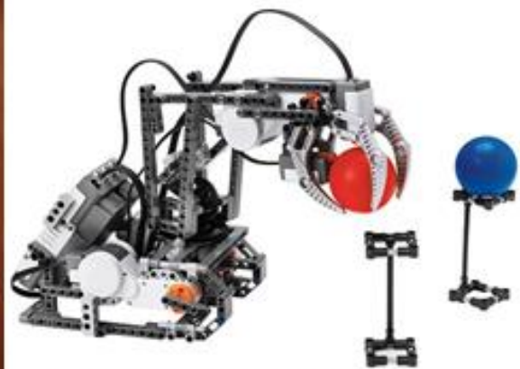
Рука-манипулятор, определяющая цвет взятого шарика
