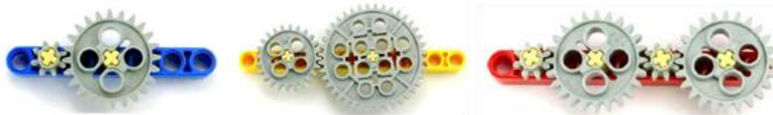
Рис.2 Передача с понижением скорости: слева i = 3:1 , справа i = 5:3 Рис.3 Две промежуточные шестерни - паразитные
