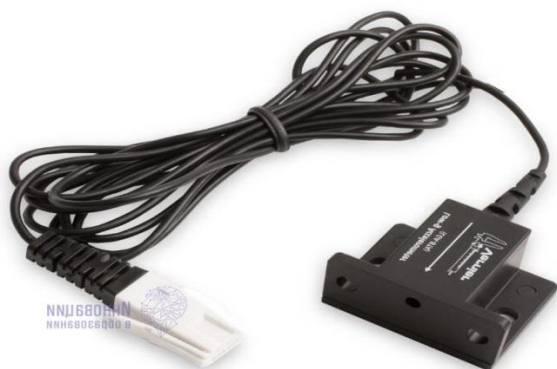
Рис. 3. Датчик ускорения (акселерометр):
