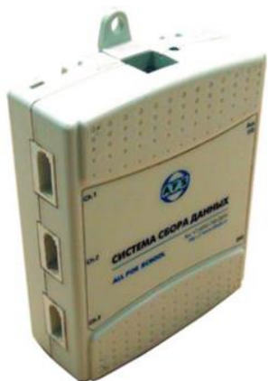
Рис. 12. Система сопряжения с компьютером Sensor DAQ.
