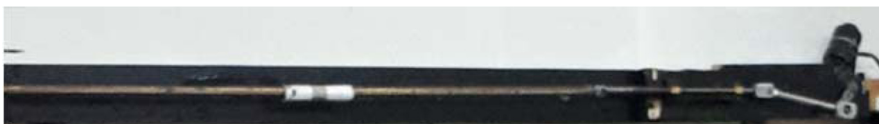
Рис. 2. Установка для изучения вынужденных колебаний
