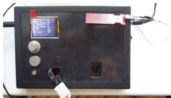
Рис. 1. Макет экомонитора и работающий прототип устройства
