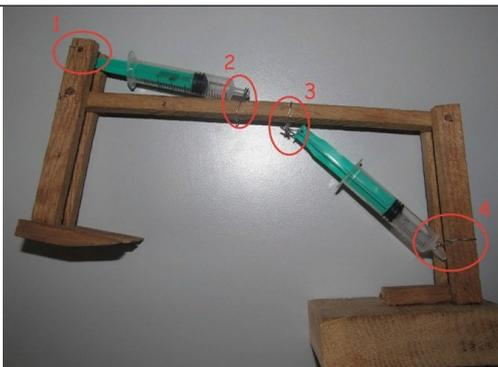
10. Присоединить трубки от капельницы к двум оставшимся шприцам и заполняем их водой. Соединить шприцы с трубками к шприцам на корпусе.
