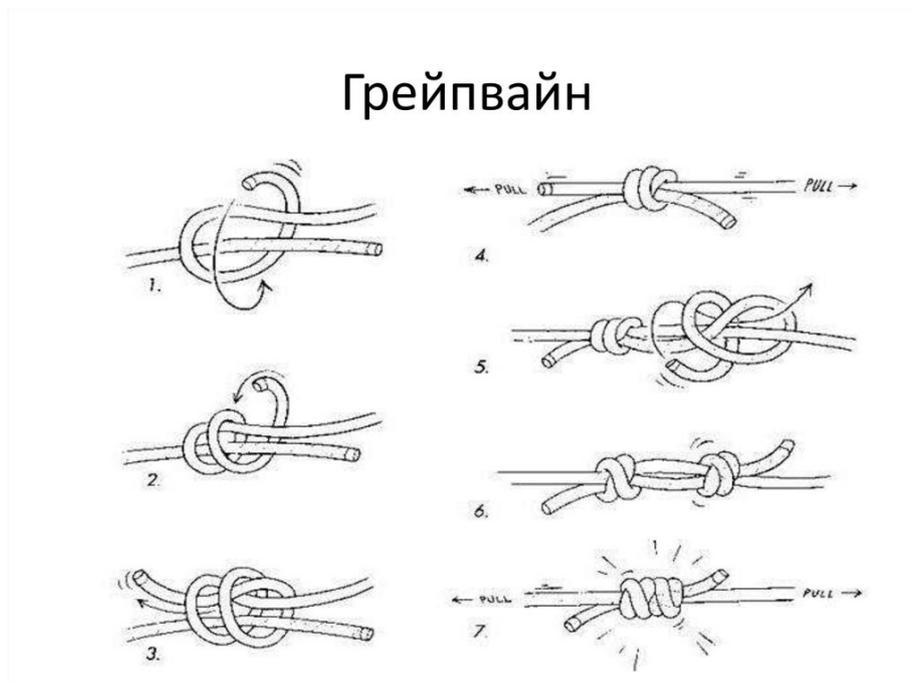
Рис.2. Схема вязания узла «Встречный»
