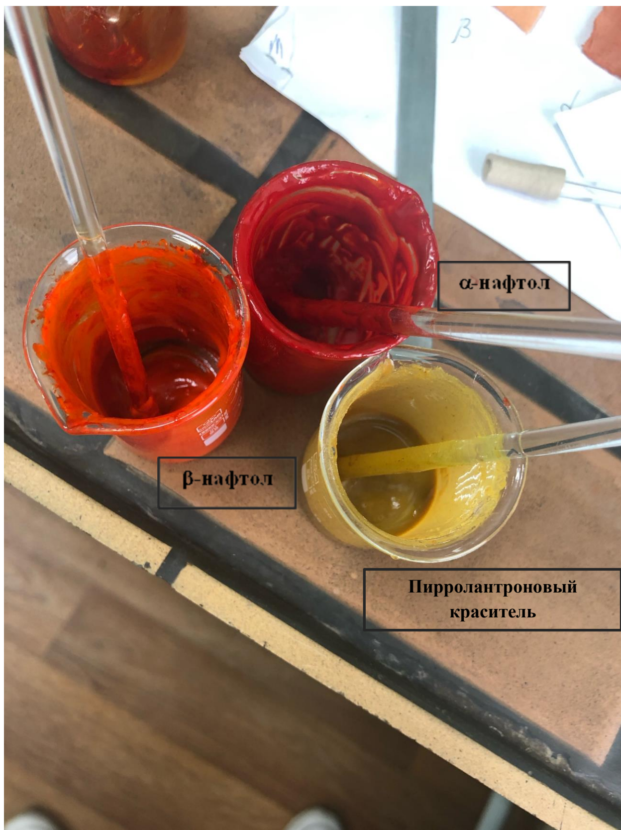
Рис. 3. Темперные краски из красителей (на основе \alpha -нафтола, \beta -нафтола и пирролантрона).
